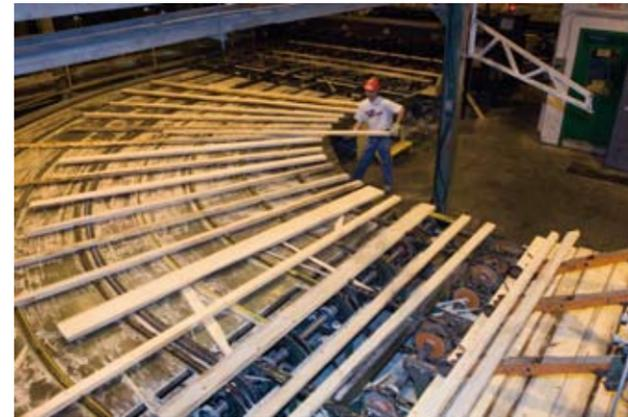
加拿大SPF板材加工厂规模有大有小，但所有厂商均遵循同一质量标准。电脑控制的高速锯木设备与电子扫描机，使木材加工过程高度机械化，保证出材质量最优化，并确保每根木材物尽其用。先进的干燥技术将木材保持在最理想湿度并使木材外观平直。几乎所有的SPF板材都是经过窑干处理的。烘干程序可提高木材的强度和硬度，改善木材尺寸的稳定性，并有助于防止木材产生污点。
