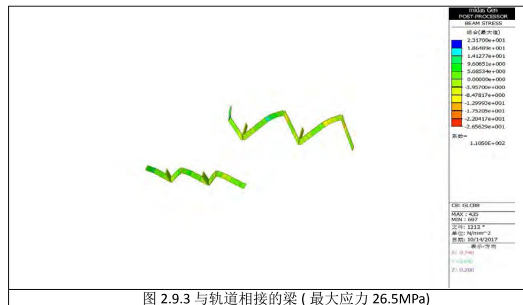
图 2.9.3 与轨道相接的梁 (最大应力 26.5MPa)
