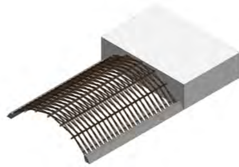
泳池空间采用贯木拱结构，通过小径木材搭接巧妙地实现大跨度空间
