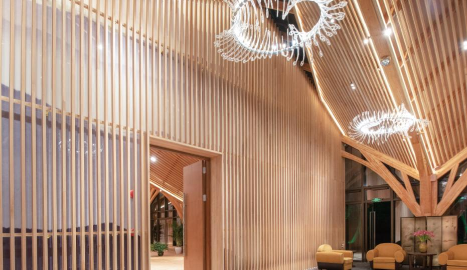
建筑形式模拟了树木生长的姿态，结构柱与三角形屋架自然交接、融为一体，柱网相互错动，形成三维的空间结构，进一步强化了空间的趣味性。屋面采用折板形态，尺度相等的折板相互错落拼合，几何逻辑清晰、简练，所形成的室内空间灵动且个性鲜明，兼具层次感与秩序感，同时又带有传统建筑质朴优雅的韵味。折板屋面顶部设置天窗，改善林间建筑幽暗的采光条件，当阳光从天窗照射下来，仿佛穿过树木的枝叶投下重重光晕。
